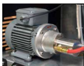
POMPE À VIDE 170 L/MIN DEGRÉ DE VIDE 0,1 MBAR
