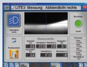
Contrôle des phares Mesure précise du réglage des phares à l'aide d'une caméra CCD.
