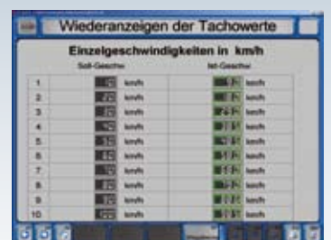
Test tachymétrique Affichage numérique de la vitesse réelle, avec possibilité de mesure de la distance parcourue.
