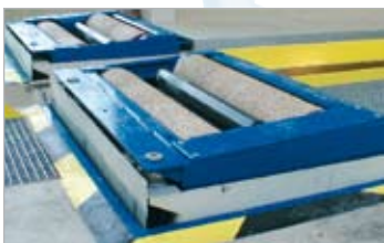
Simulateur de poids Simulation de poids ou jeu de roue surélevé selon les pays.
