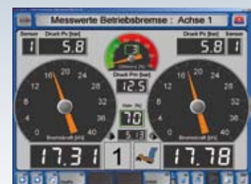
Contrôle du freinage Lors du test de freinage, les données importantes sont présentées de manière claire.
