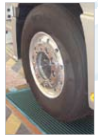
Contrôle du ripage
