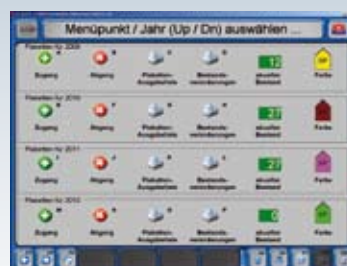
Gestion des plaquettes de contrôle Gestion entièrement automatique des plaquettes de contrôle avec justificatif de stock. Fonction de rappel des délais pour le contrôle principal et le contrôle de sécurité des véhicules des clients.
