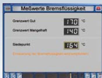
Contrôle du liquide de freinage Détection précise du point d'ébullition du liquide de freinage avec interprétation du résultat.
