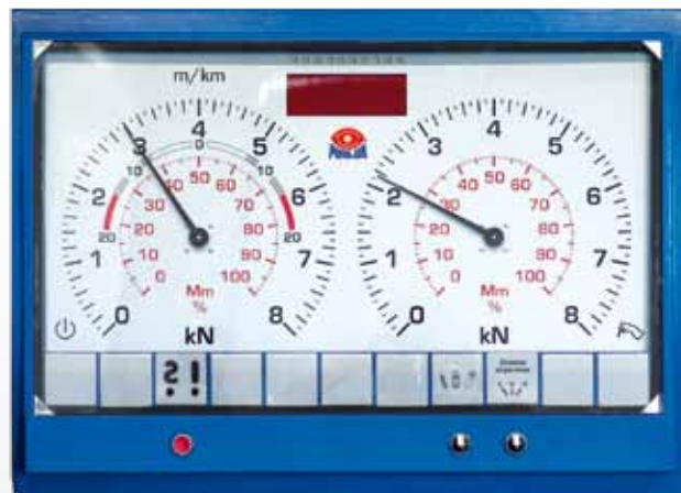
Multi-affichage analogique pour l'affichage des valeurs de mesure des freins, de l'amortissement par essieu, des plaques de ripages, ainsi que des éléments de circuit.
