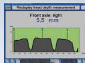
Jauge de profondeur TM 1000 Affichage numérique de la profondeur de la sculpture pour chaque pneu (en option).
