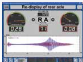
Essai d'amortissement par essieu Contrôles de la capacité d'amortissement du véhicule.
