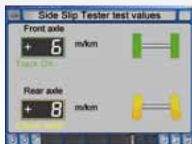
Contrôle passage de roue Contrôle rapide de la géométrie pour le diagnostic de l'alignement.
