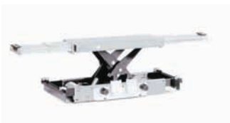
Zusatzheber 2.000 kg, 2.600 kg oder 4.000 kg optional erhältlich. Hubhöhe ca. 250 mm, max. Höhe ca. 430 mm, Aufnahmebreite ca. 1.610 mm. 3 Verlängerungen, Automatische Sicherheitsvorrichtung mit 4 Positionen. Jacking beam 2.000 kg, 2.600 kg or 4.000 kg optional available. Lifting height approx. 250 mm, max. height approx. 430 mm, overall width approx. 1.610 mm. 3 extensions, automatic safety device with 4 positions.
